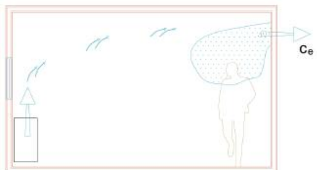
Slika 2. Izvor onečišćenja blizu odsisnog otvora
