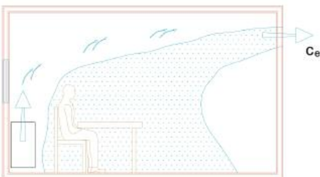
Slika 3. Izvor onečišćenja udaljen od odsisnog otvora
